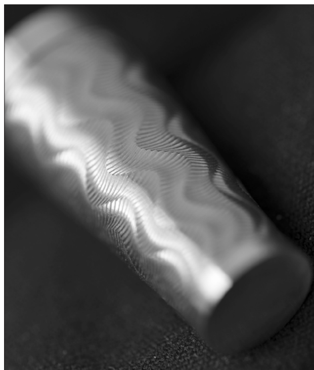
Fig. 2: Exemple de guillochage en 3D.
