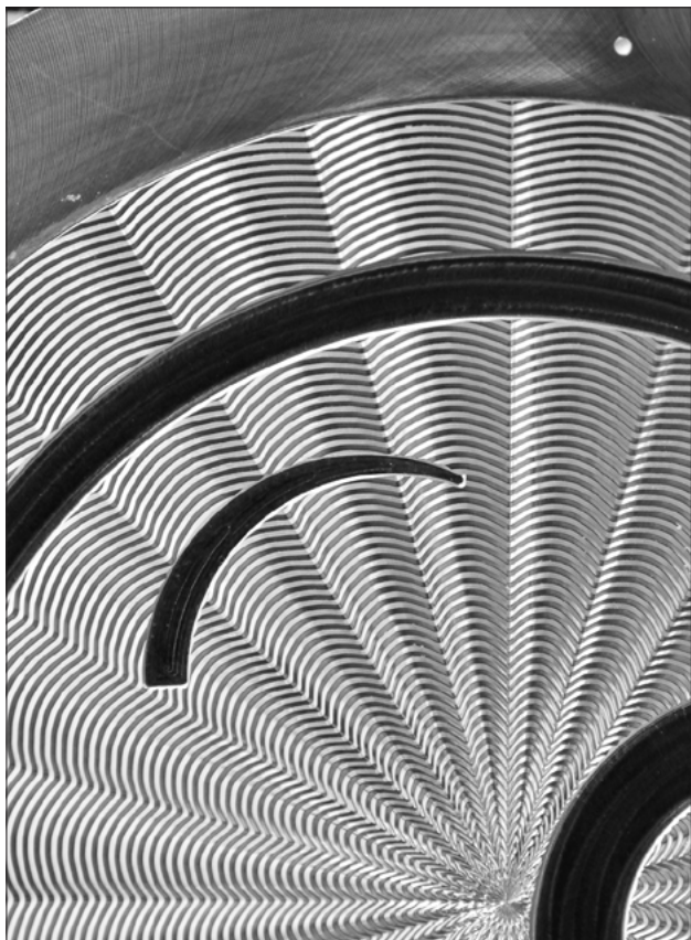
Fig. 1: Exemple de couplage d'usinage conventionnel et guillochage.
